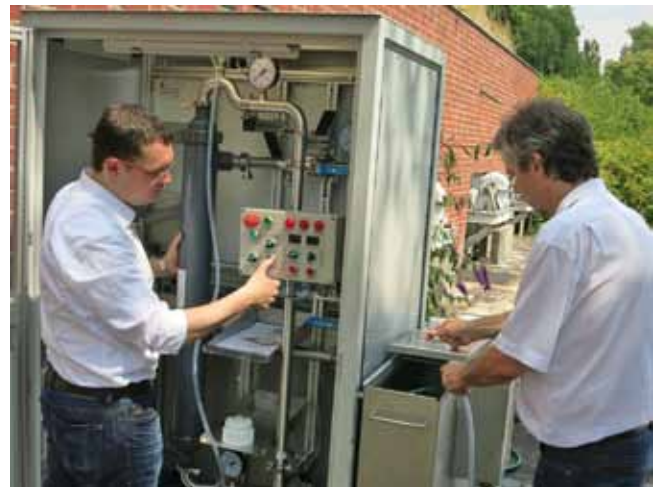
Abb. 1: Inbetriebnahme der kontinuierlichen Crossflow-Ultrafiltration. Foto: Daniel Karthe
